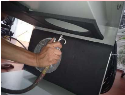
Ilustración 15: limpieza de rueda silica
