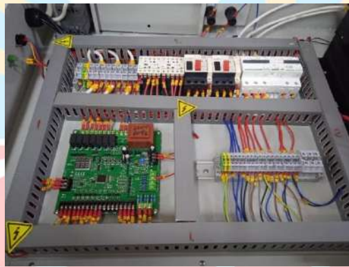
Ilustración 11: tablilla de conexiones
