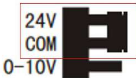
Alimentación del instrumento al transmisor.
