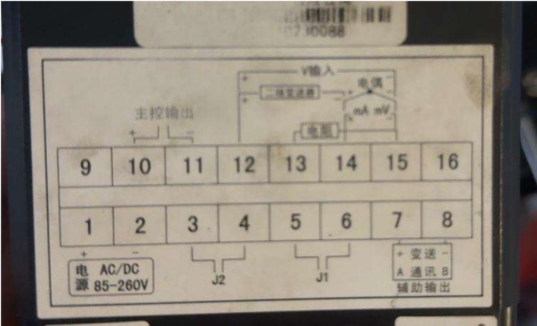
Etiqueta posterior del XMT624. En esta variante, la salida Master se identifica en 10 (+) y 11 (-).
