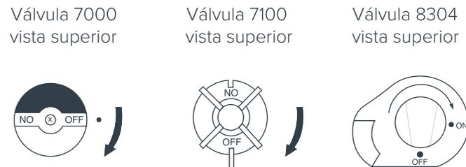
10. Si el piloto y quemador principal no han encendido en aproximadamente 1 minuto, mueva el interruptor de suministro de energía eléctrica a la posición "APAGADO" (OFF) y luego a la posición "ENCENDIDO" (ON). Esto volverá a iniciar el ciclo de ignición.
