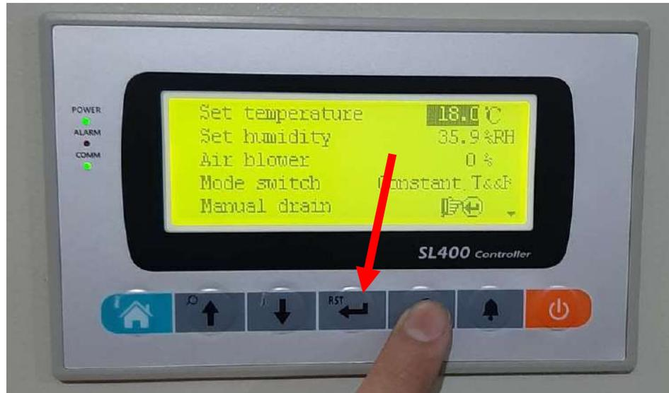
Para modificar la humedad deseada, presione nuevamente el botón con el símbolo de la llave, el número se marcará con un recuadro. Presione los botones con las flechas para modificar la humedad deseada, presione ENTER para fijar la humedad deseada.
