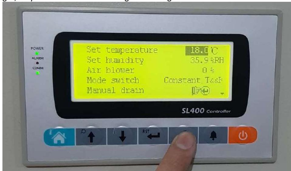
Modifique los valores presionando las flechas, una vez determinada la temperatura, presione ENTER (se indica con una flecha roja en la siguiente imagen)
