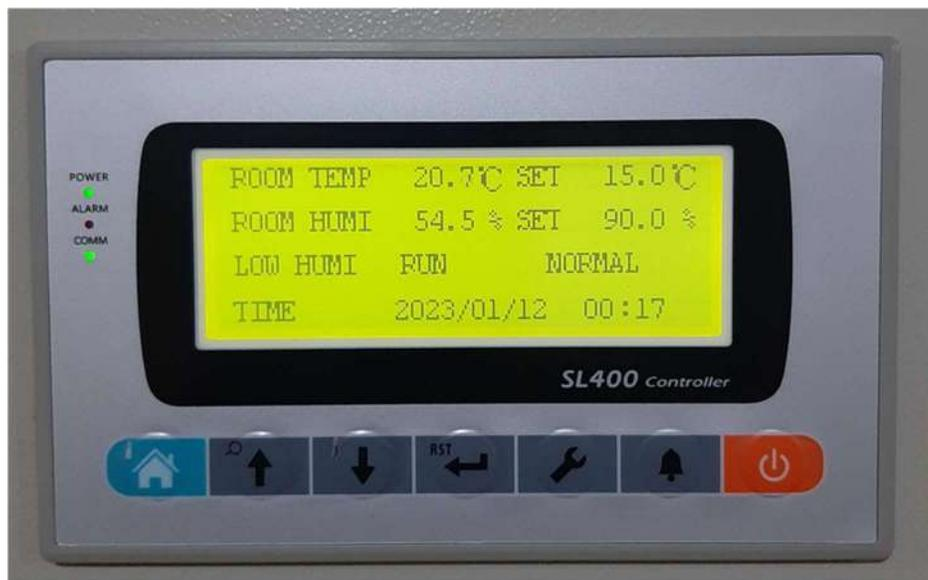
15. En la pantalla se mostrará la humedad y la temperatura del cuarto y los valores programados, una vez asegurado que los valores programados sean correctos, presionamos el botón de encendido de color naranja para arrancar el equipo
