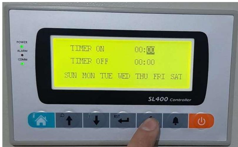
9. Modifique las horas y los minutos del equipo encendido y apagado. Para cambiar de los minutos a las horas y los días, presionar el botón con el símbolo de la llave. Para cada parámetro que modifique presione ENTER para que se establezca el valor.
